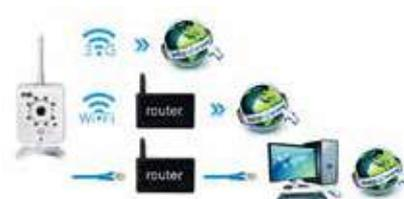
**Collega la telecamera** al tuo router Internet: puoi scegliere se usare il Wi-Fi o un comune cavo di rete: non c'è bisogno di configurare niente, la telecamera è già on-line!
